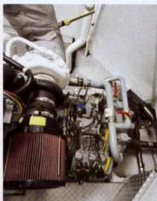
Il sistema idraulico Servogear che regola la trasmissione.
